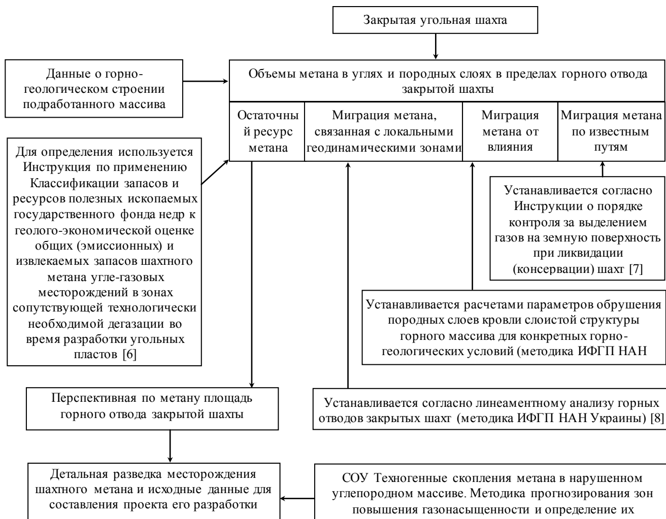
Рис. 1 – Схема к определению объемов газа, накопившегося в подработанном массиве закрытой шахты
