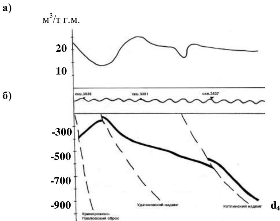
Рис. 8 – Изменение газоносности угольного пласта  $d_4$  (а) и схематический разрез вкрест простирания горных пород (б) на поле шахты «Красноармейская-Западная № 1»
