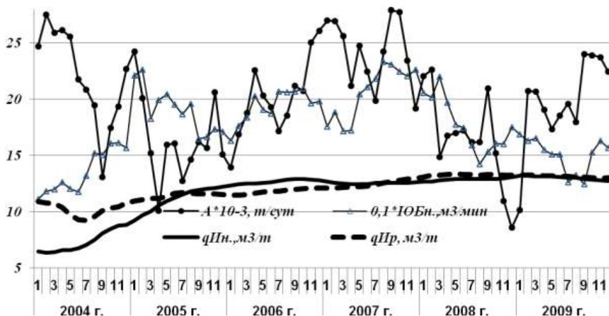
$A$  – среднесуточная добыча в рассматриваемом месяце, т/сут;  $I_{\text{ОБн}}$  – среднее значение абсолютной метанообильности шахты в рассматриваемом месяце, м<sup>3</sup>/мин;  $q_{\text{Ир}}$  – интегральная метанообильность шахты по методу ИМА, м<sup>3</sup>/т;  $q_{\text{Ин}}$  – то же, (натурное значение), м<sup>3</sup>/т
