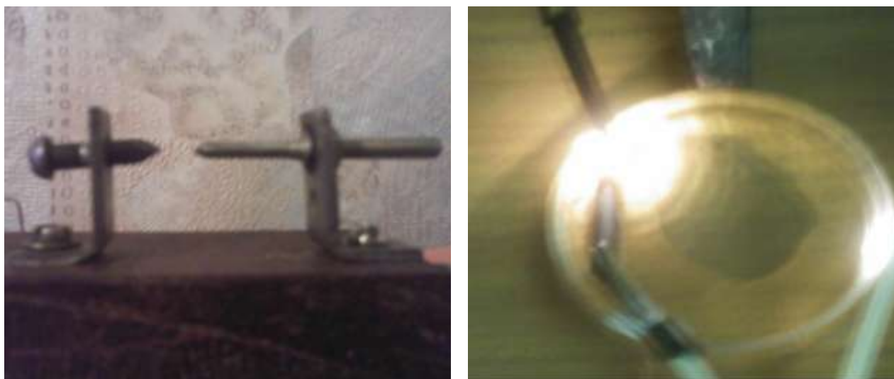
Рис. 2 – Формирующийся воздушный промежуток (а) и образец угля в электрической дуге (б)
