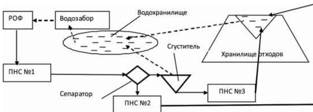
Рисунок 6 – Схема отведения отходов обогащения и оборотного водоснабжения с разделением пульпы на выходе из магистрали гидротранспортного комплекса возле хранилища или на промежуточной ПНС
