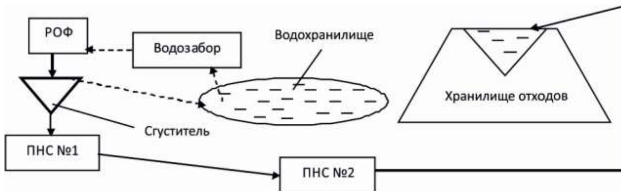
Рисунок 2 – Схема отведения отходов обогащения и оборотного водоснабжения со сгущением пульпы на ПНС гидротранспортного комплекса рядом с РОФ
