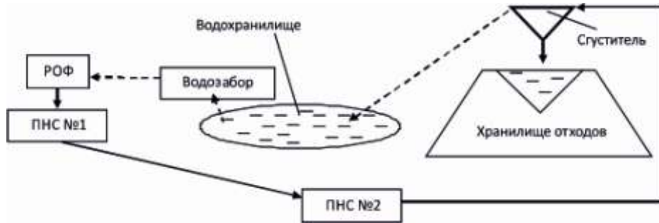
Рисунок 4 – Схема отведения отходов обогащения и оборотного водоснабжения со сгущением пульпы непосредственно возле карты намыва
