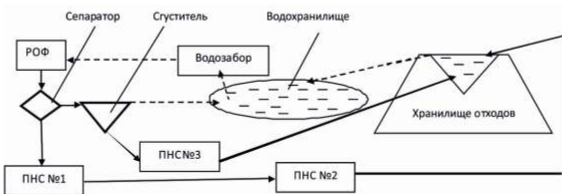
Рисунок 5 – Схема отведения отходов обогащения и оборотного водоснабжения с разделением пульпы на ПНС гидротранспортного комплекса рядом с РОФ
