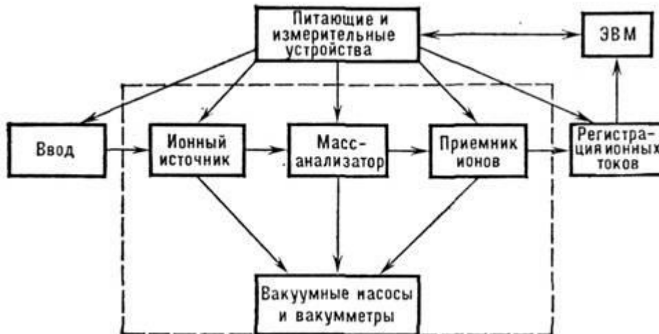
Рисунок 1 – Принципиальная схема метода ВИМС
