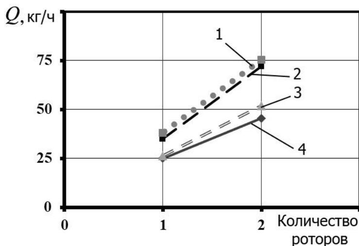
1- известняк (экспериментальные значения); 2 – известняк (модельные значения); 3 – гранит (экспериментальные значения); 4 – гранит (модельные значения)
