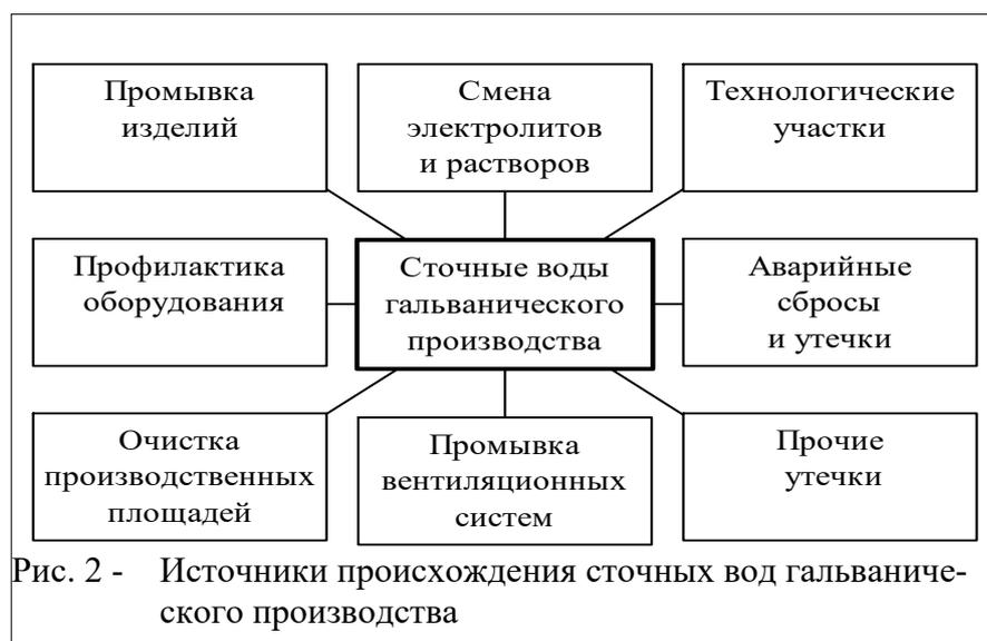
Рис. 2 - Источники происхождения сточных вод гальванического производства
