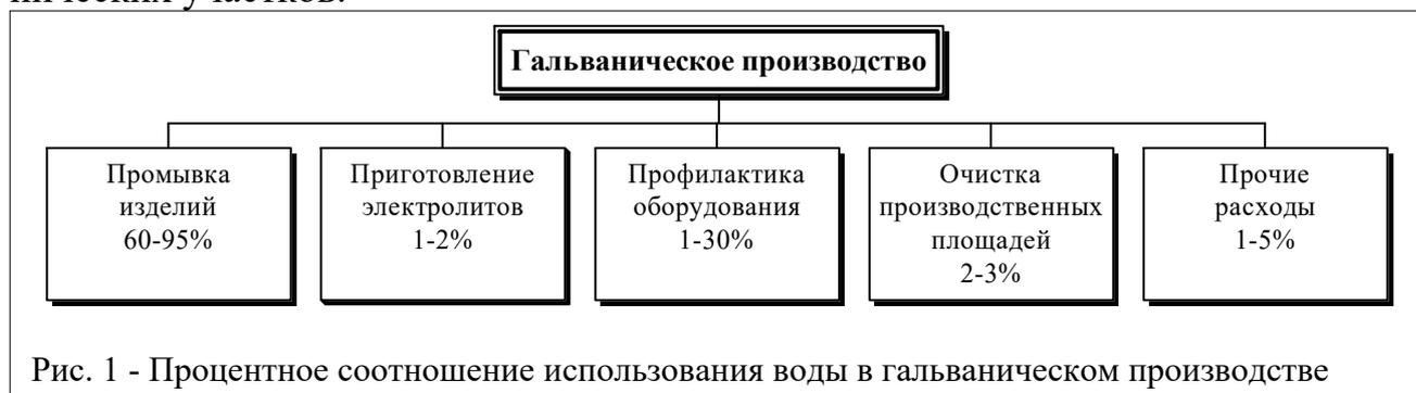
Как видно из схемы технологического процесса гальванического производства (рисунок 1) вода является необходимым компонентом практически всех операций, связанных с подготовкой поверхности изделий к нанесению покрытия, приготовлением и корректировкой электролитов, профилактикой оборудования, очисткой готовых изделий и производственных площадей.
