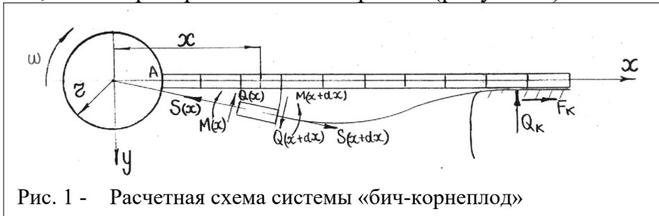
Рис. 1 - Расчетная схема системы «бич-корнеплод»
