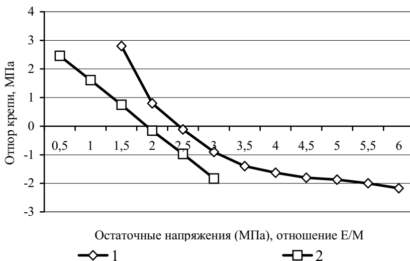
Рис. 2 – Закономерности изменения отпора крепи от характеристик остаточной прочности (1) и отношения модулей упругости и спада (2).
