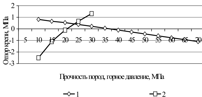
Рис. 1 – Изменение отпора крепи в зависимости от прочности пород (1) и горного давления (2).
