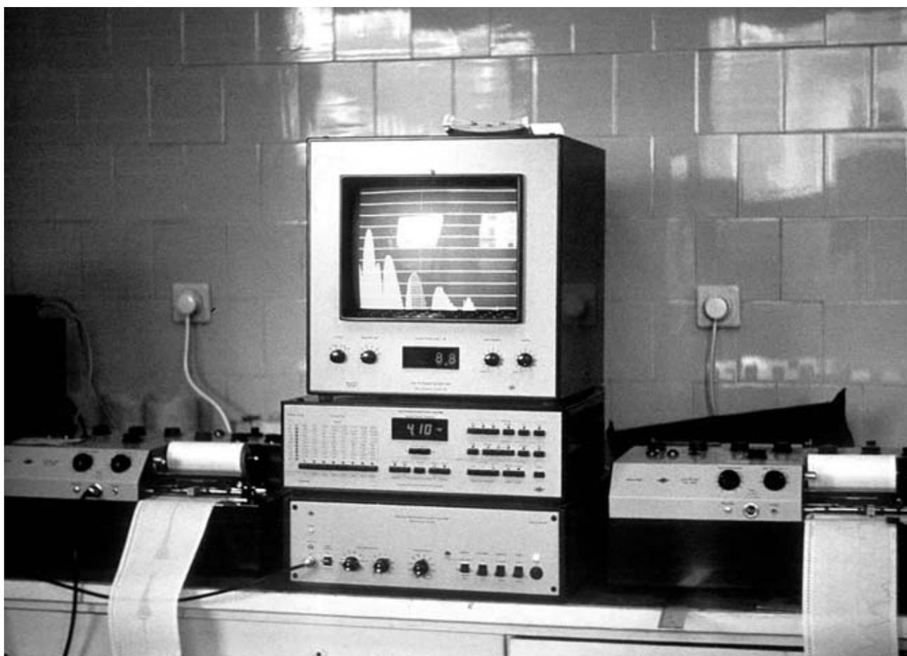
Рис. 2 – Аппаратурный комплекс фирмы «Брюль-Кьер» для обработки данных, записанных на магнитограф, при работе в режиме спектрального анализа вертикальных колебаний клетки
