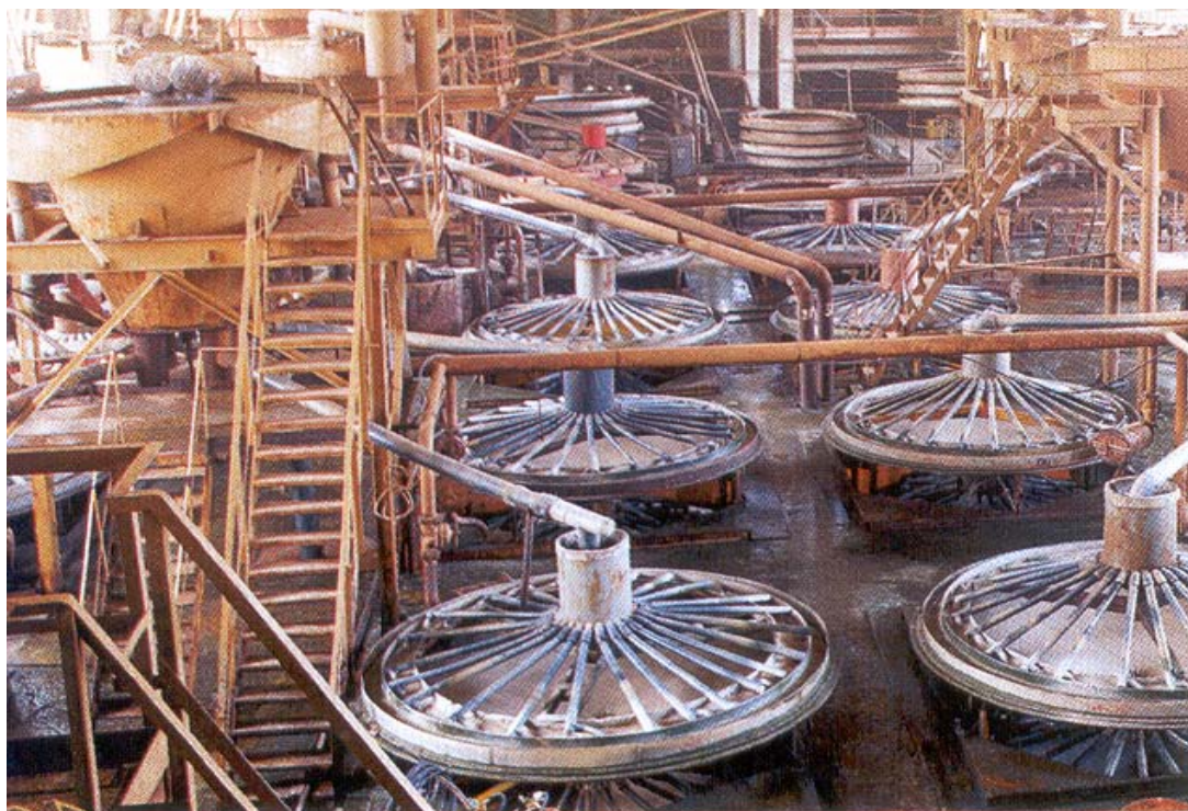
Рис. 2 – Конусные сепараторы в отделении гравитационных методов обогащения обогатительной фабрики ВГМК
