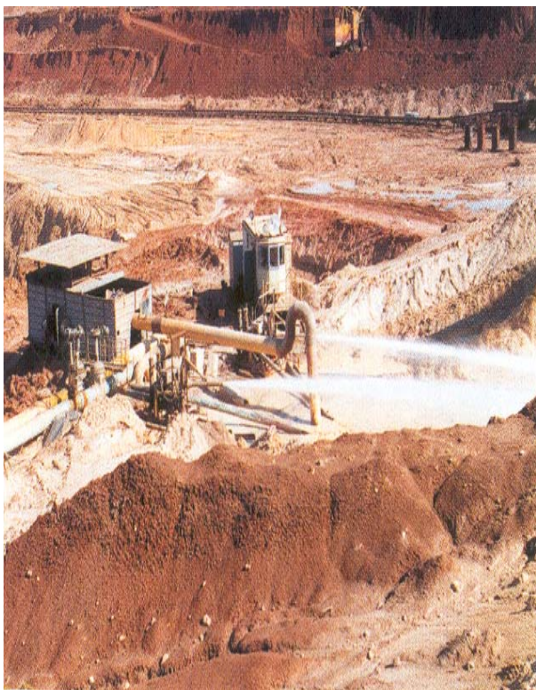
Рис. 3 – Узлы пульпообразования на головных ПНС первой (А) и второй (Б) очередей гидротранспортного комплекса ВГМК
