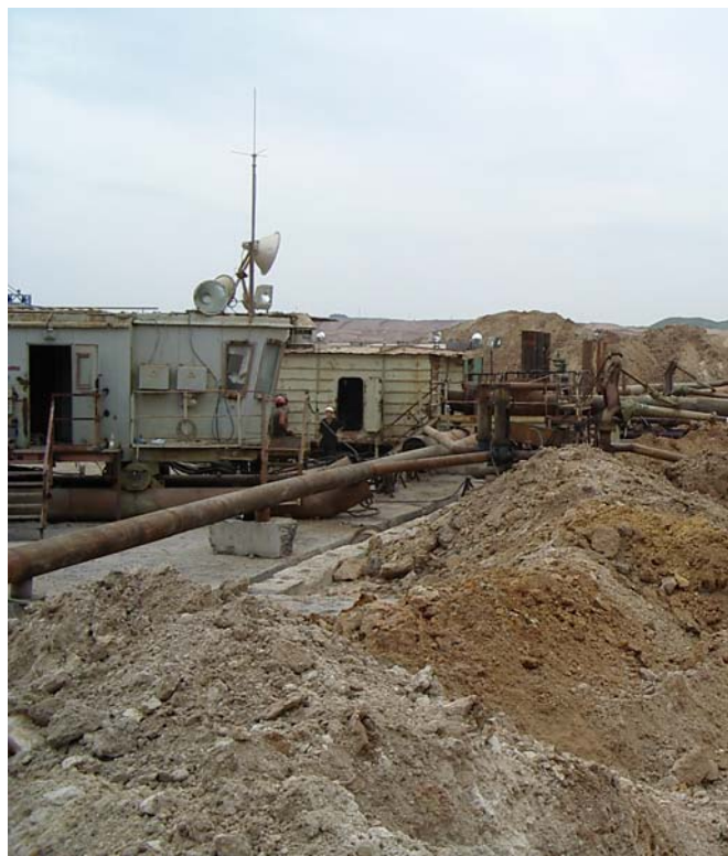
Рис. 3 – Узлы пульпообразования на головных ПНС первой (А) и второй (Б) очередей гидротранспортного комплекса ВГМК
