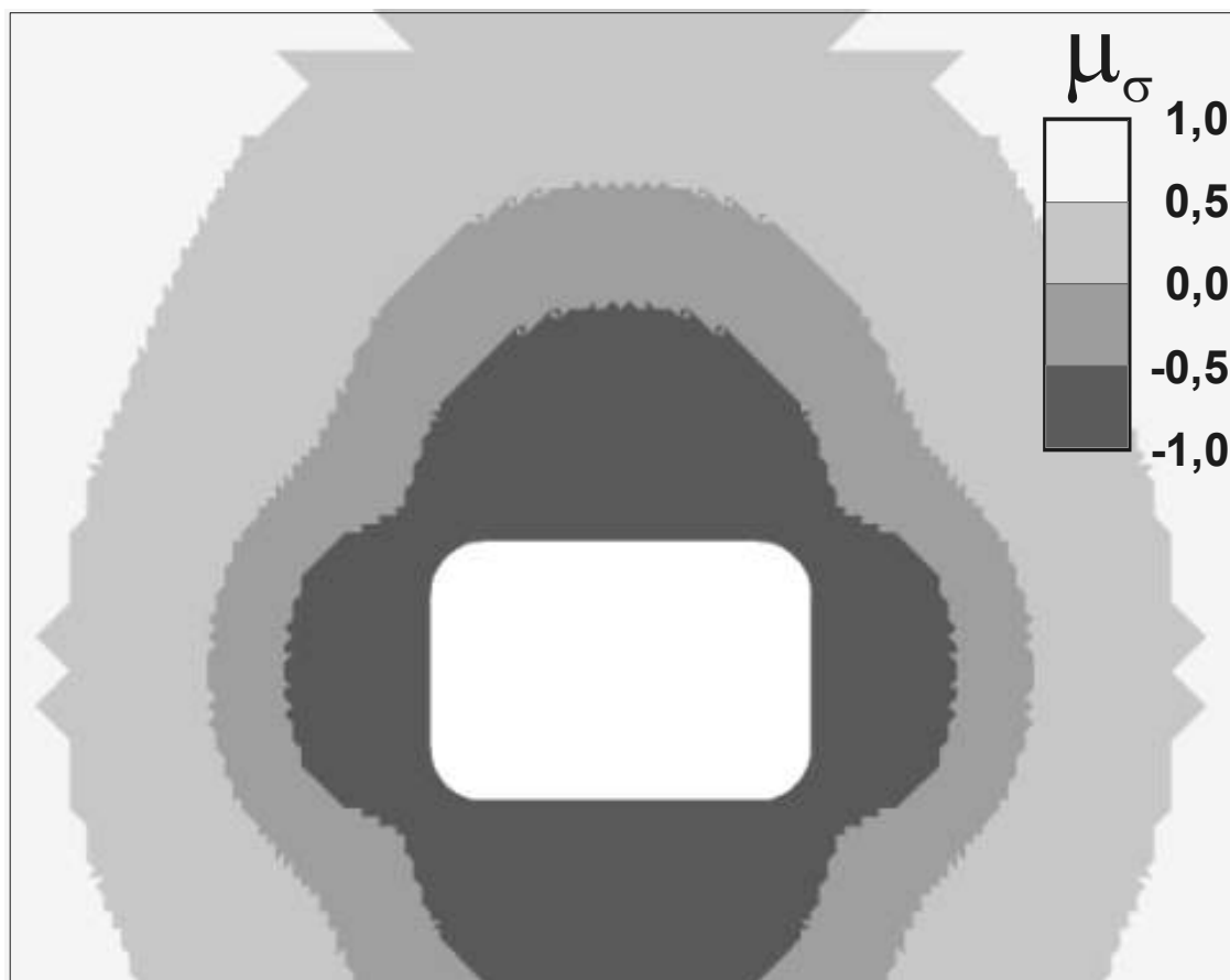
Рис. 3 - Распределение параметра Лоде-Надаи вокруг незакрепленной одиночной горной выработки.
