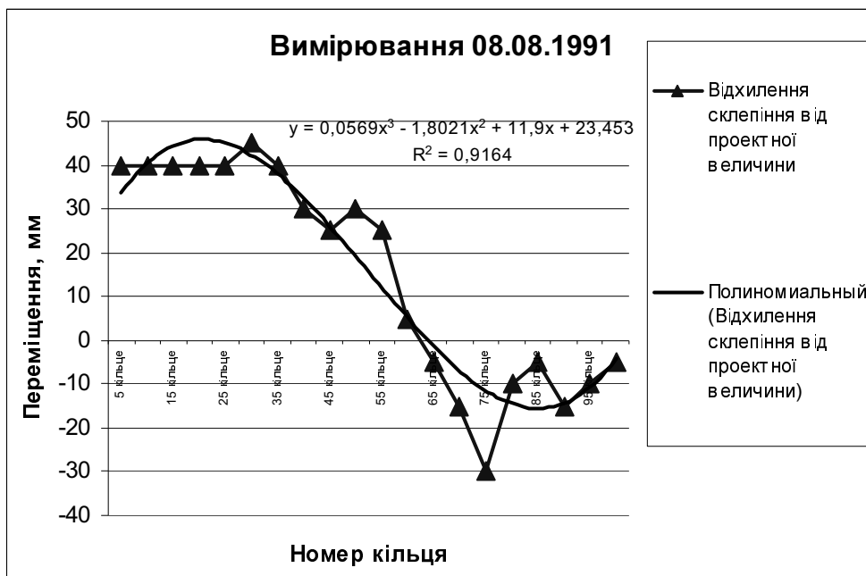
Рис. 5 – Апроксимація кривої відхилення склепіння від проектної величини по довжині тунелю
