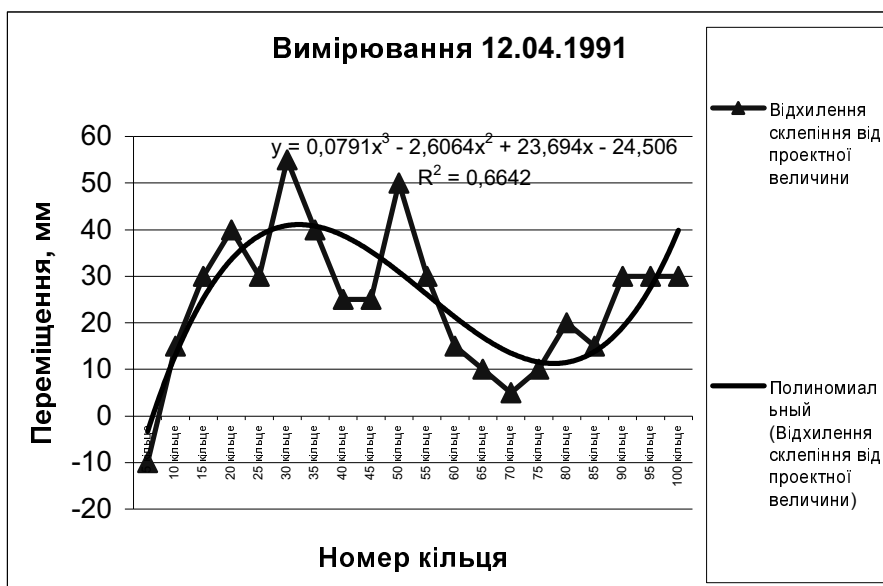
Рис. 3 – Апроксимація кривої відхилення склепіння від проектної величини по довжині тунелю
