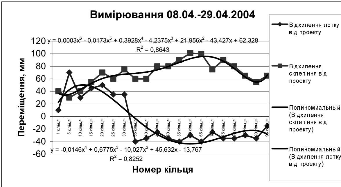
Рис. 1 – Апроксимація кривої відхилення лотку та склепіння від проектної величини по довжині тунелю („Сирець”)
