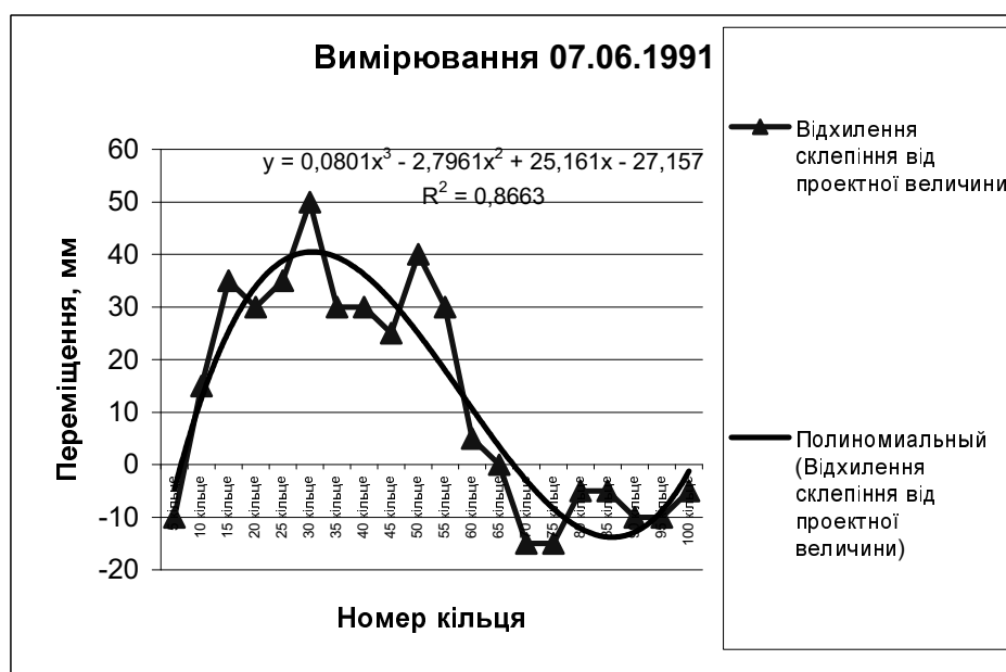
Рис. 4 – Апроксимація кривої відхилення склепіння від проектної величини по довжині тунелю
