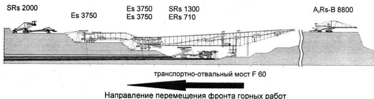
Рис. 4 – Системы разработки с применением транспортно-отвального моста F60 на разрезе Яншвальде
