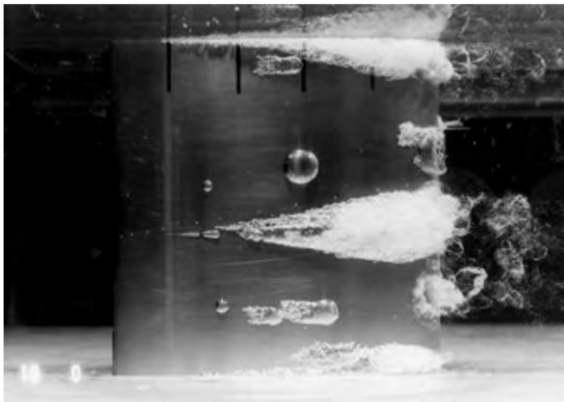
Рис. 8 – Прослеживание явления кавитации на стенде в лабораторных условиях
