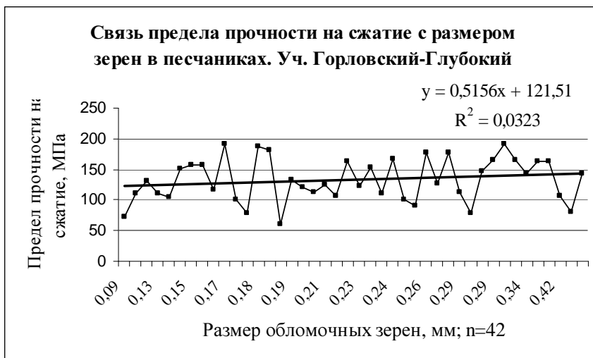
Рис. 4 – Графическая зависимость прочности от размера зерен для уч. Горловский-глубокий, Центрального района
