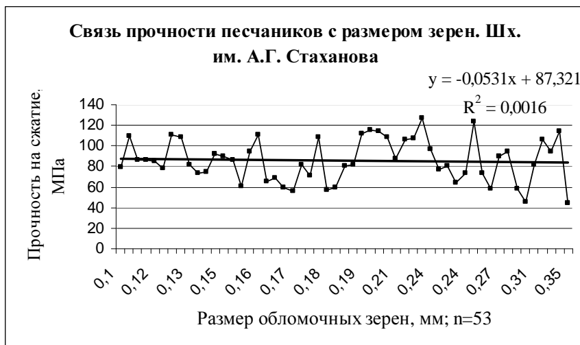
Рис. 3 – Графическая зависимость прочности от размера зерен для шх. им. А.Г. Стаханова, Красноармейского района
