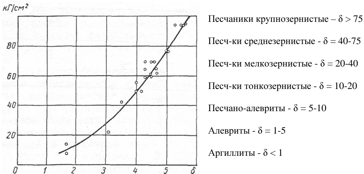
Рис. 1 – Связь прочности с гранулометрическим составом и значения структурного коэффициента \delta [6]
