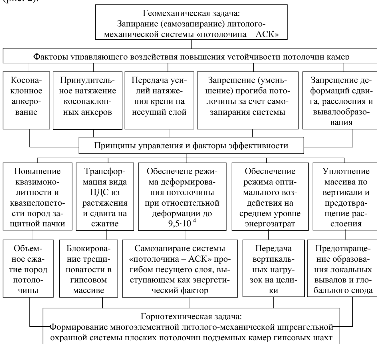
Рис. 2 – Матрица факторов воздействия и принципов управления состоянием потолочин камер с помощью АСК
