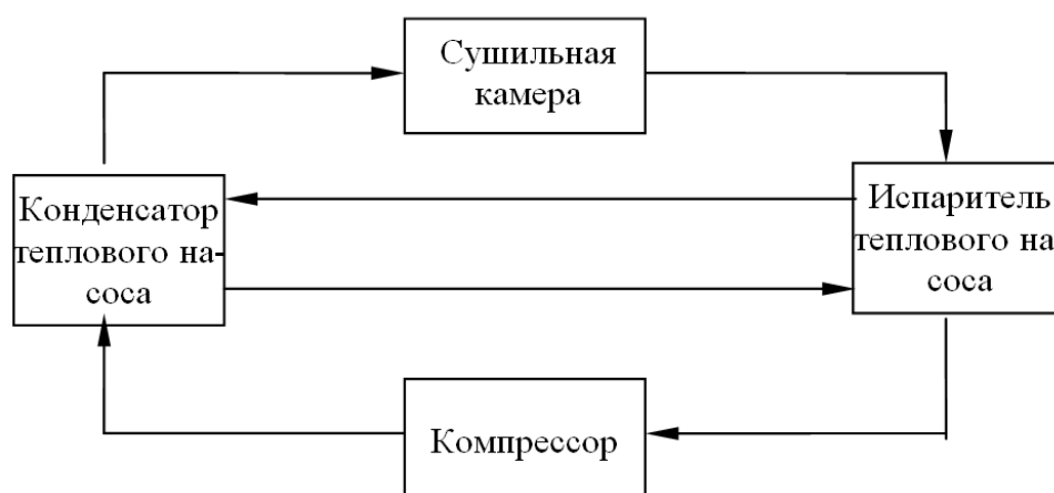
Рис. 1 – Принципиальная блок-схема сушки влажных материалов с помощью ТНС
