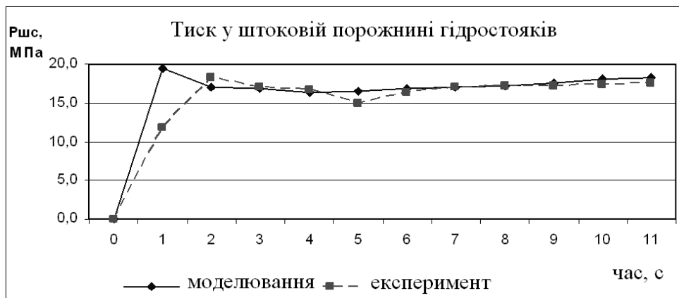
Рис. 7 - Графіки зміни тиску у штоковій порожнині гідростояків при пересуванні секції кріплення 1М88Н
