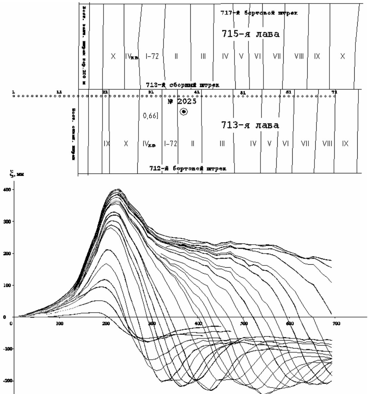
Рис. 1 – График горизонтальных сдвижений реперов наблюдательной станции №8
