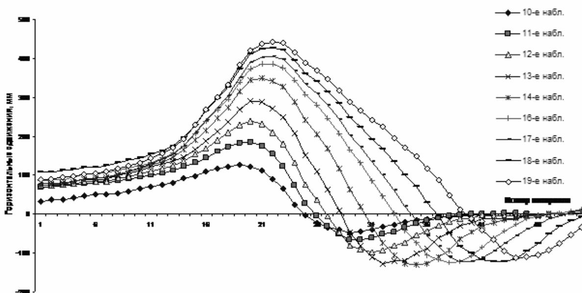
Рис. 3 – График распределения горизонтальных сдвижений, рассчитанных от неподвижных реперов над целиком со стороны движущегося забоя лавы
