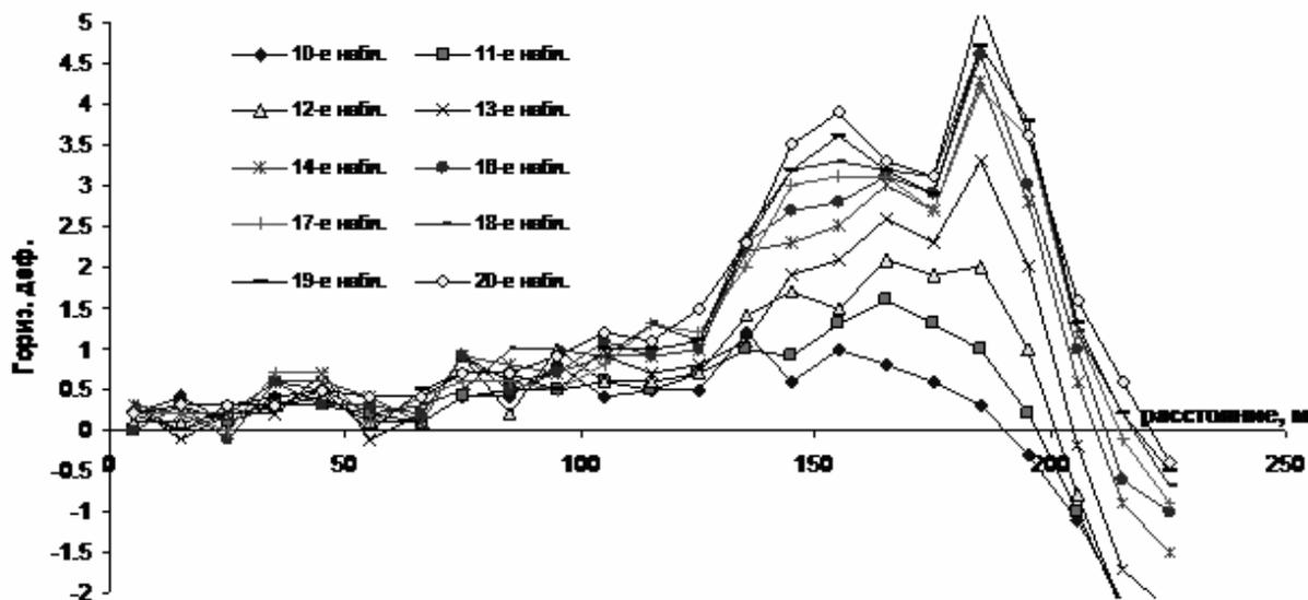
Рис. 2 – Фрагмент графика развития горизонтальных деформаций на профильной линии наблюдательной станции №8
