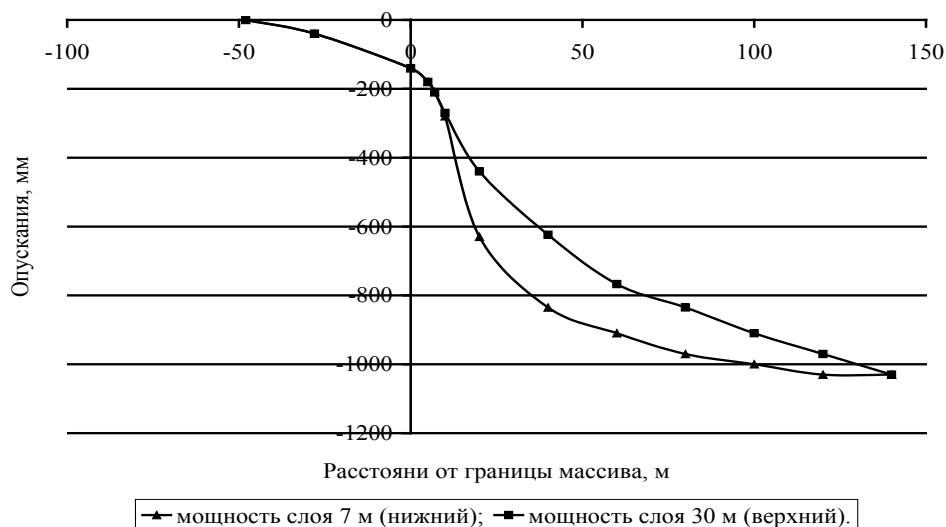
Рис. 3 – Зависимость опусканий слоев мощностью 30 м верхний и 7 м нижний при скорости подвигания очистного забоя 5 м/сут
