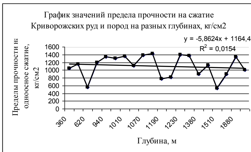
Рис. 6 - График изменения значений предела прочности на сжатие для Криворожских кварцитов на глубину до 2 км
