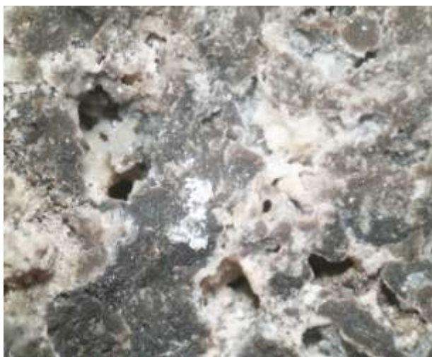
Рис. 2 – Поры в гераклитах с заливообразными границами. Поверхность пустот покрыта мелкокристаллическим игольчатым кальцитом
