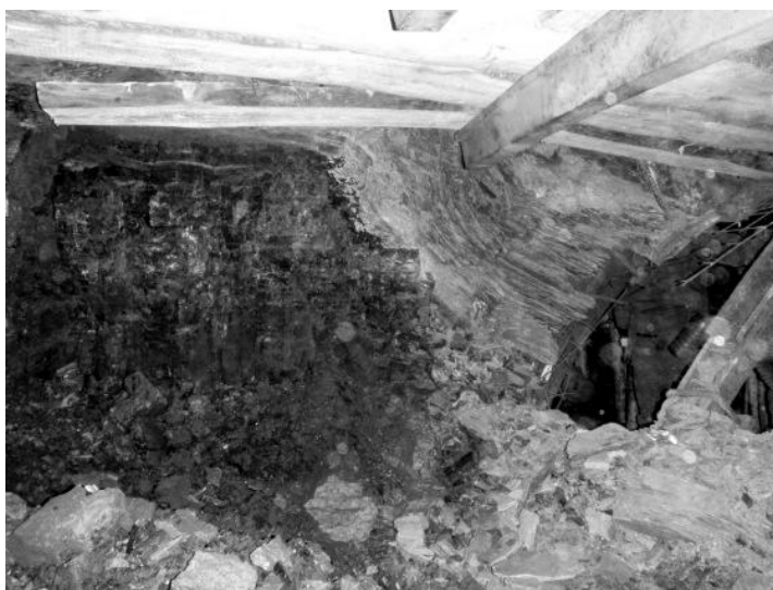
Рис. 3 – Загибание и разрушение краевой части пласта
