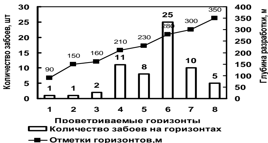
Рис.4 - Распределение забоев (потребителей воздуха) по горизонтам шахты "Ингульская"
