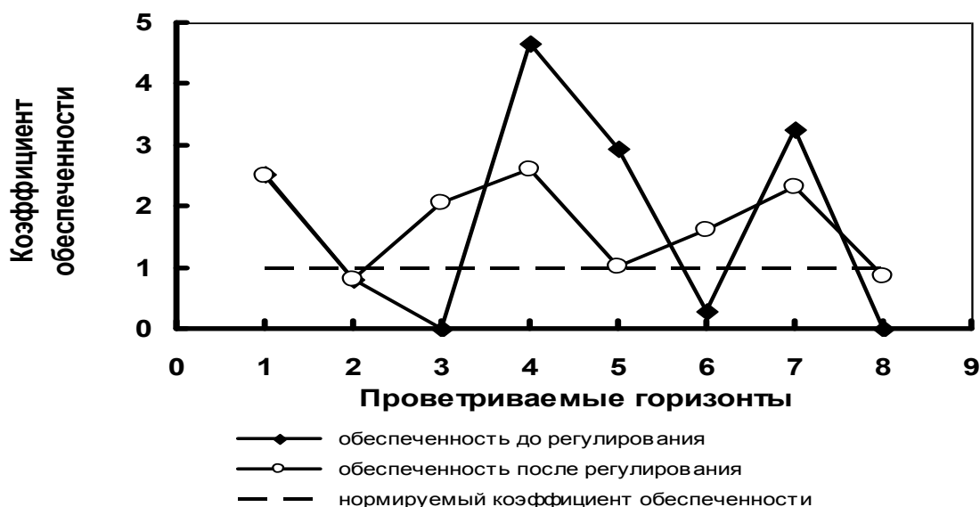
Рис.3 - Обеспеченность рабочих горизонтов шахты "Смолинская" расчетным количеством воздуха до и после его перераспределения
