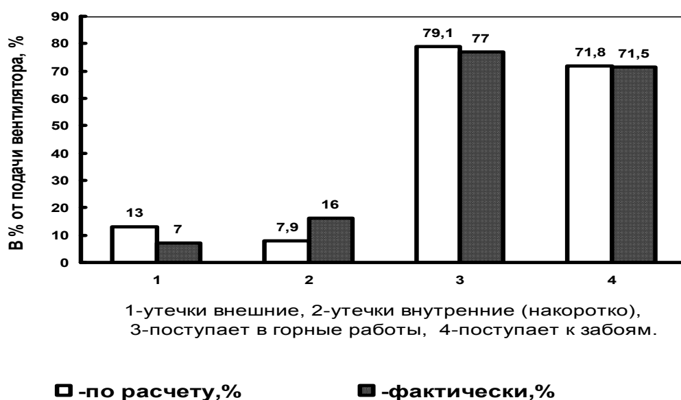
Рис.5 - Расчетное и фактическое использование подачи вентиляторов главного проветривания шахты "Ингульская"
