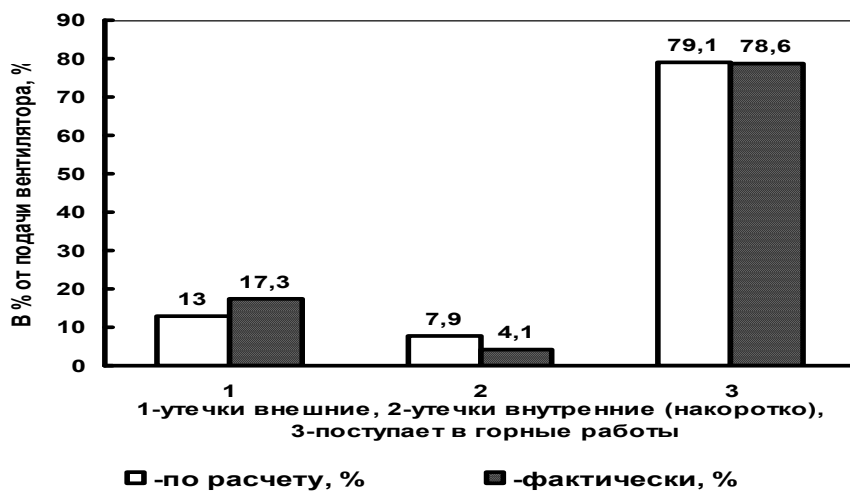
Рис.2- Расчетное и фактическое использование подачи вентилятора главного проветривания шахты «Смолинская»
