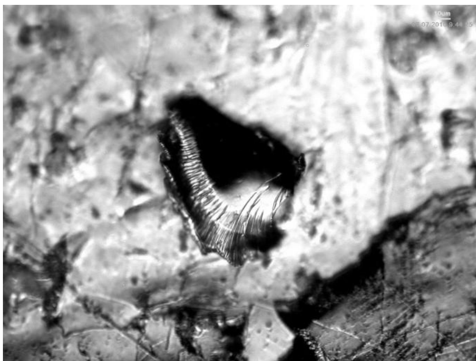
Рис. 3 – Развернутая оболочка пузырька с газом
