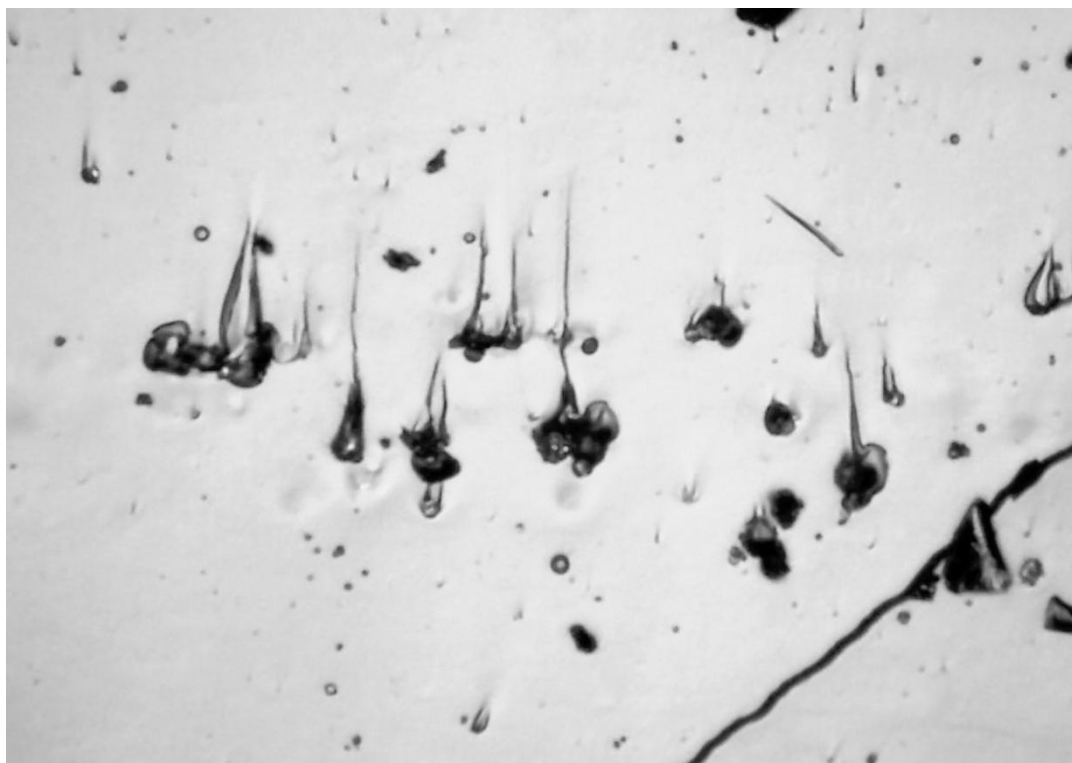
Рис. 6 – Трещины в угле, образованные в результате развития газового пузырька
