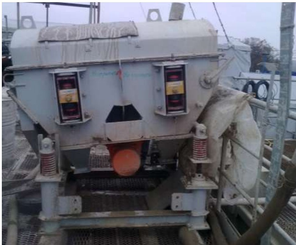
Рисунок 4 – Грохот МВГ в технології очистки бурового розчину на буровій „Володарська-2” ПАТ „Шахта О.Ф. Засядька”
