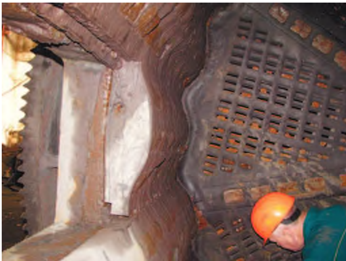
Рис. 4 – Волновой характер футеровки «G.M-волна» после 4-х месяцев наработки; СевГОК, мельница \varnothing 3,6 м, первая стадия измельчения, шары \varnothing 100 мм
